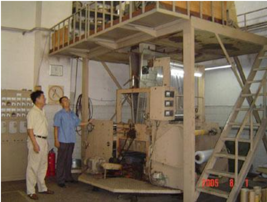
图二：研制的五层共挤下吹（水冷）高分子复合膜生产机组
